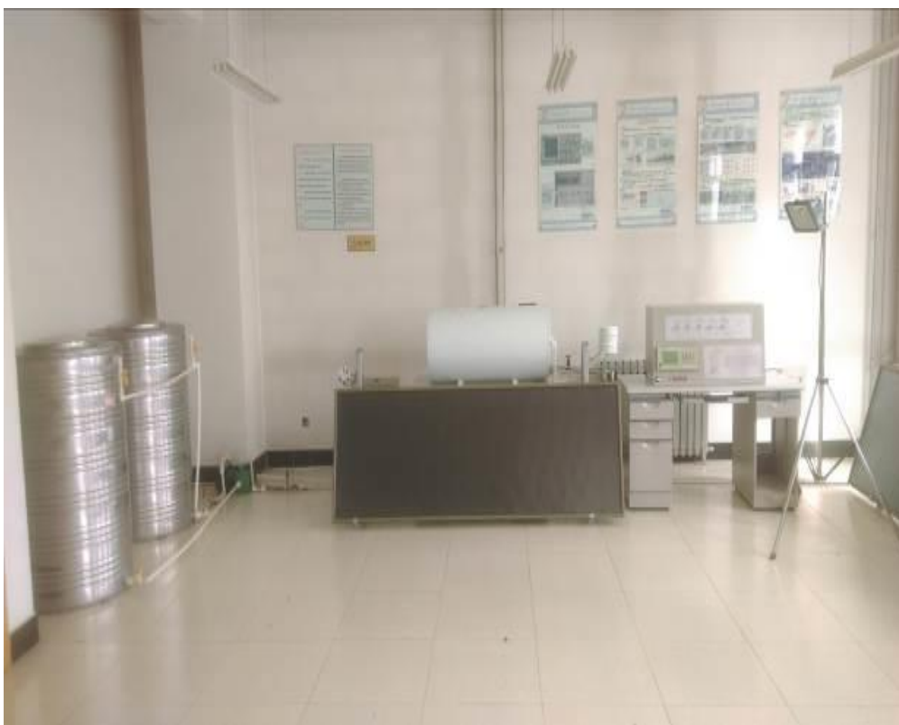
图 4 太阳能采暖系统实物图
