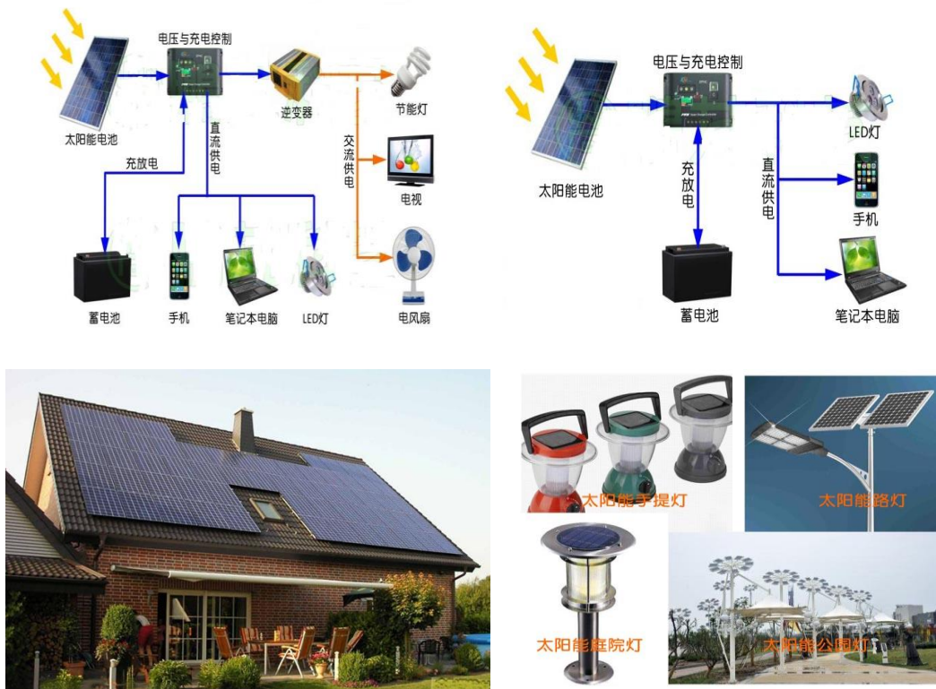
图 18 太阳能独立光伏发电系统及其应用
